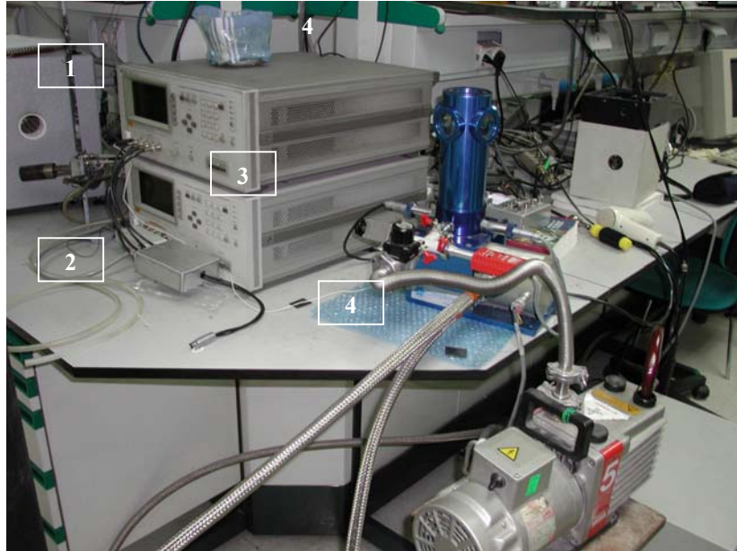
Fotografía 1: Vista general del equipo de medida de impedancias: (1) Horno tubular horizontal, (2) Célula de medida, (3) Analizadores de impedancia y (4) Criostato.
